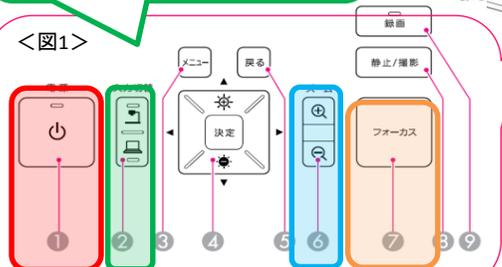
①【電源】ボタン(図1-①)を押して、電源を入れる。
