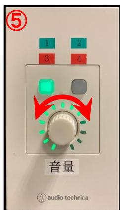
AVラック左側面の音声コントロールパネル(⑤)のノブを回すことで音声の音量を調整できます。
