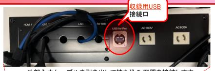
外部入力ケーブルを引き出して持ち込み機器を接続します。 収録用のUSBを接続します。(※詳細は9・10ページ)
