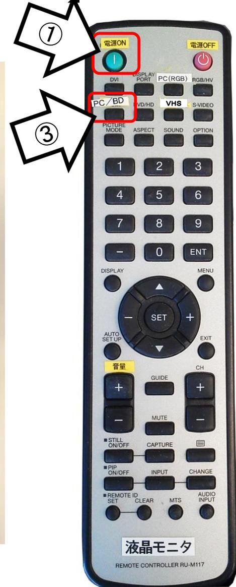
使用後は①の主電源スイッチをOFFにし、PCの電源を切ってHDMIケーブルを抜く
