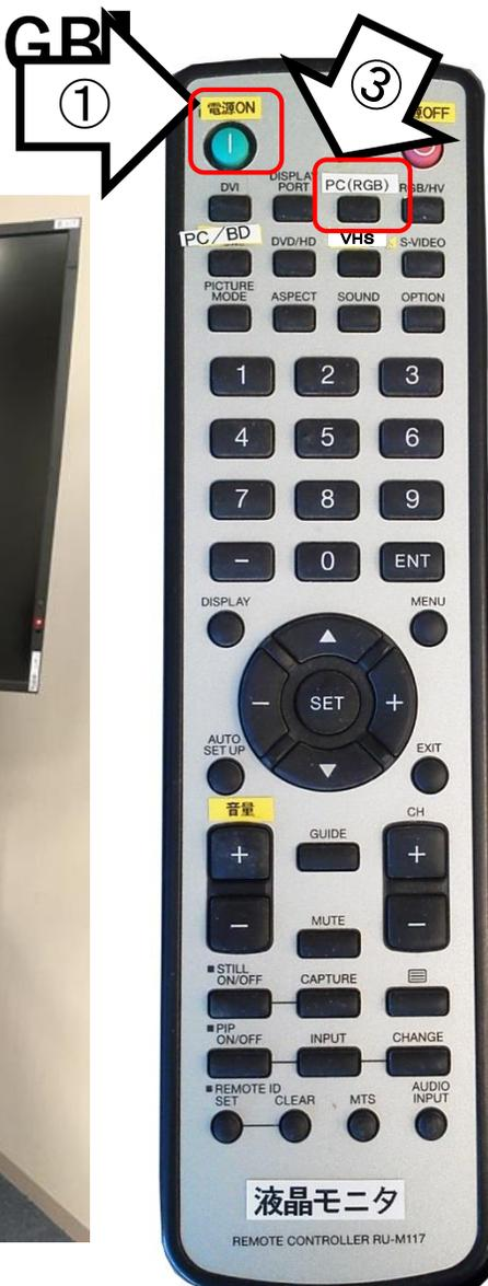
使用後は①の主電源スイッチをOFFにし、PCの電源を切ってRGB、音声ケーブルを抜く
