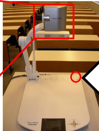
使用後は①の主電源スイッチをOFFにして、⑤の書画カメラ本体の電源を切る
